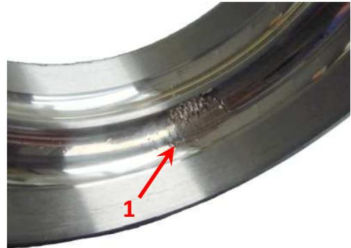
Un montaje invertido del rodamiento provoca una anomalía del calculador ABS (código defecto, testigo ABS). La sustitución por un nuevo rodamiento es necesaria. En el momento del montaje del rodamiento, verificar que el lado equipado del codificador magnético se encuentra del lado interior del vehículo (lado captador).
