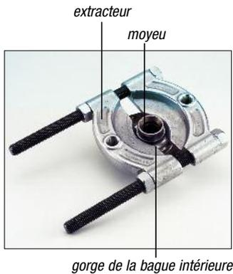
**5** Placer l'extracteur sous la presse en appui soit sur un tube soit sur cales. A l'aide d'un tube de diamètre approprié, pousser sur le moyeu pour le dégager de la bague intérieure.
