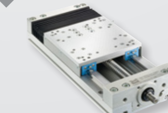
AXLT BAUREIHE Baugröße 155, 225, 325, 455 • Besonders geeignet für hohe Belastungen, insbesondere Momentenbelastungen • Geschütztes Antriebs- und Führungssystem durch optionalen Faltenbalg • Kombinierbar zu Kreuztischversionen
