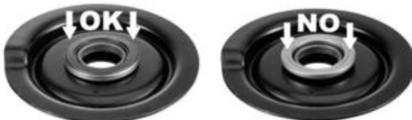
**Respetar el sentido de montaje del axial: cara metálica no visible**
