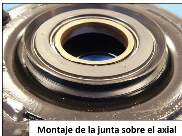
Montaje de la junta sobre el axial
