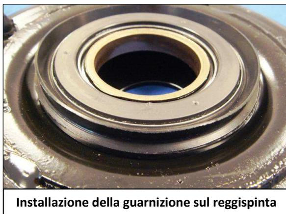
**Rispettare il senso di montaggio della guarnizione : labbro stagno lato blocco filtrante**
