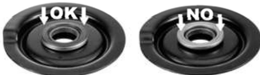
**Rispettare il senso del montaggio del reggispinta: non si deve vedere la faccia metallica**
