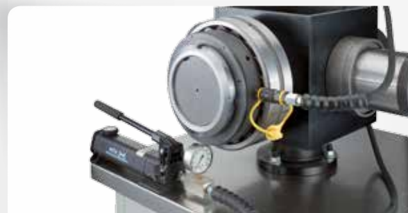
Montagem com bucha de desmontagem com porca hidráulica
