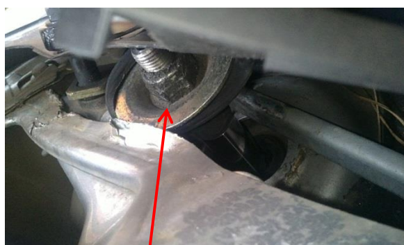
Zestaw łożyska zawieszenia z poduszką niskiej jakości
