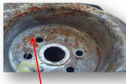
Korozja spowodowana przez ruch sprężyny
