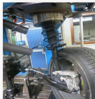
Stanowisko pomiarowe zawieszenia w Centrum Testowym NTN-SNR
