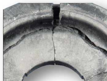
Uszkodzone łożysko amortyzatora Pęknięte gniazdo łożyska amortyzatora
