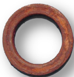
Zniszczona uszczelka Skorodowane łożysko amortyzatora na skutek przenikania substancji zanieczyszczających
