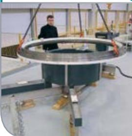
Questo dispositivo speciale sviluppato per un'applicazione eolica è in grado di riscaldare a 120°C in 60 minuti, pezzi con peso fino a 10 tonnellate con un diametro esterno di 4 metri.
