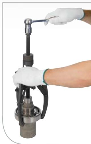
Uma gama de ferramentas simples, robustas e eficazes para uma desmontagem fácil e sem risco dos rolamentos de pequena e média dimensão.
