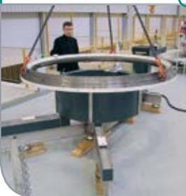
Esse dispositivo foi desenvolvido especialmente para uma aplicação eólica é capaz de aquecer a 120°C em 60 minutos, peças pesando até 10 toneladas com um diâmetro externo de 4 metros.
