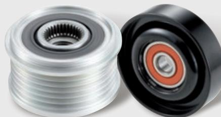
**ATTENZIONE!** bisogna controllare e/o cambiare la puleggia a ruota libera d'alternatore quando si sostituisce la cinghia
