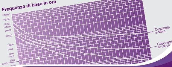
Tale frequenza di base deve essere corretta dai coefficienti indicati di seguito, in funzione delle condizioni ambientali particolari del meccanismo (polvere, umidità, urti, vibrazione, asse verticale, temperatura di funzionamento...) secondo la relazione:  $F_c = F_b \times T_e \times T_a \times T_t$ .
