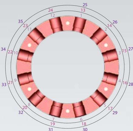
Avvitare gli elementi pompanti (chiave 12 mm) e gli otturatori (chiave esagonale da 6 mm) con una coppia di 10 Nm.
