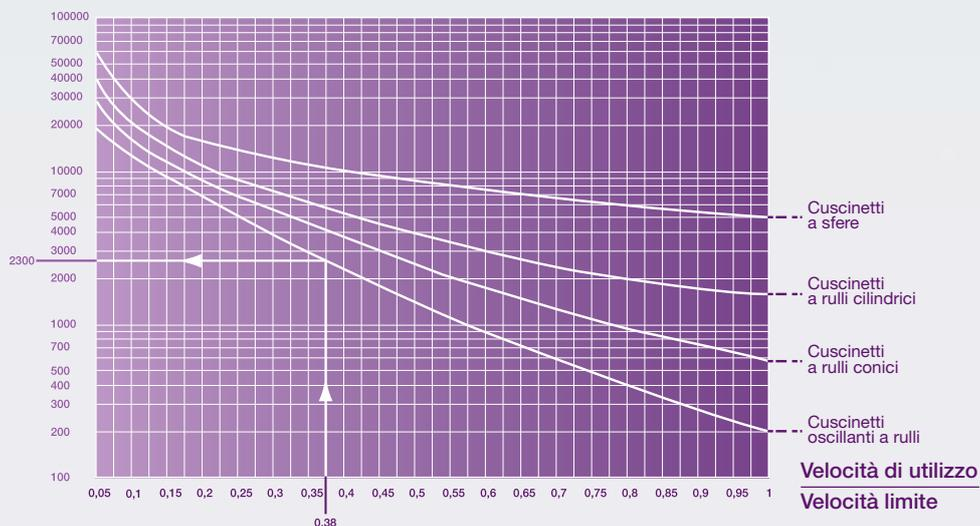
La frequenza di base ( $F_b$ ) di rilubrificazione dipende dal tipo di cuscinetto e dal rapporto tra la velocità d'utilizzo e la velocità limite, indicata nelle caratteristiche del cuscinetto.
