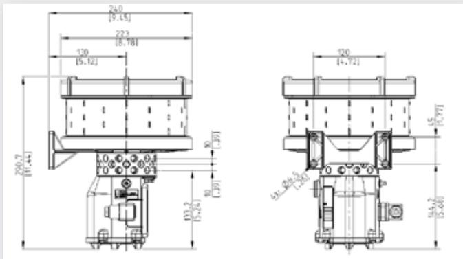
NRUN: modello destinato ai veicoli industriali. Il collegamento con attivazione generale (NRUN) consente l'utilizzo della pompa con la macchina in controllo a circuito chiuso. La pompa funziona solo in presenza del segnale di attivazione, altrimenti rimane in modalità stand-by; il segnale di attivazione esterno è un segnale logico standard +5V.
