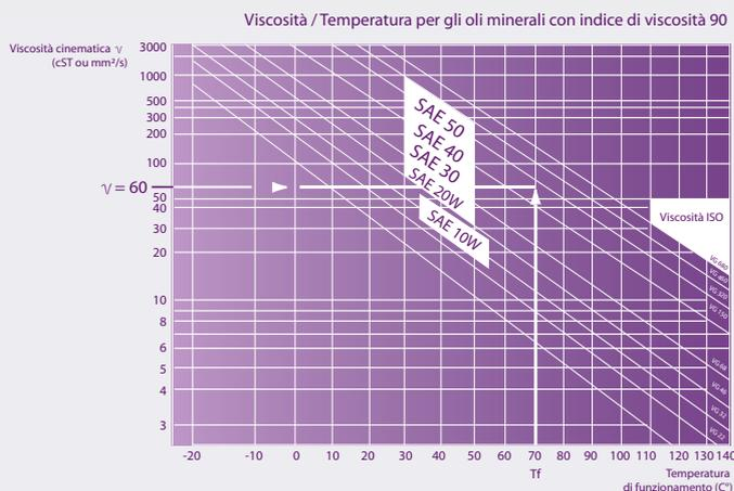
Sulla scala verticale, riportare il valore della viscosità di base calcolata.
