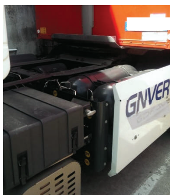
Les réservoirs sont situés de chaque côté du tracteur
