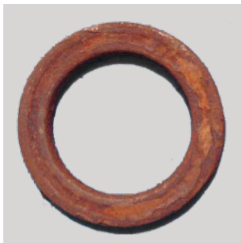
*TOPE DE SUSPENSIÓN CON CORROSIÓN DEBIDO
