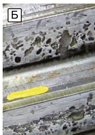
Фото Б. Значительное сглаживание сколов на роторном колесе через 5 месяцев после перехода на Eco Gear 460 M
