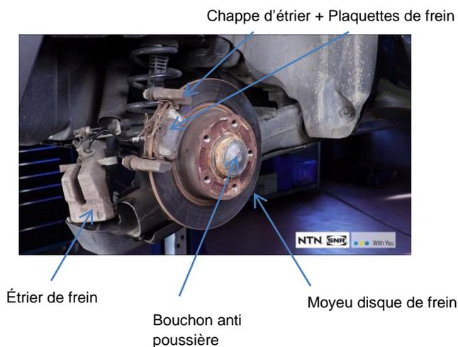
2. avant de procéder à l'installation du moyeu disque neuf :
