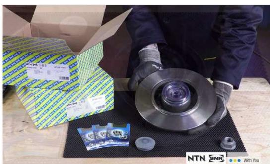
4. prima di iniziare l'installazione del mozzo disco freno nuovo, per quelli dotati della tecnologia ASB®, togliere la protezione prima del montaggio. Non urtare il codificatore magnetico. Non avvicinarlo ad una superficie sporca e/o magnetica. Controllare l'uniformità dei poli magnetici del codificatore con la scheda test ASB®.
